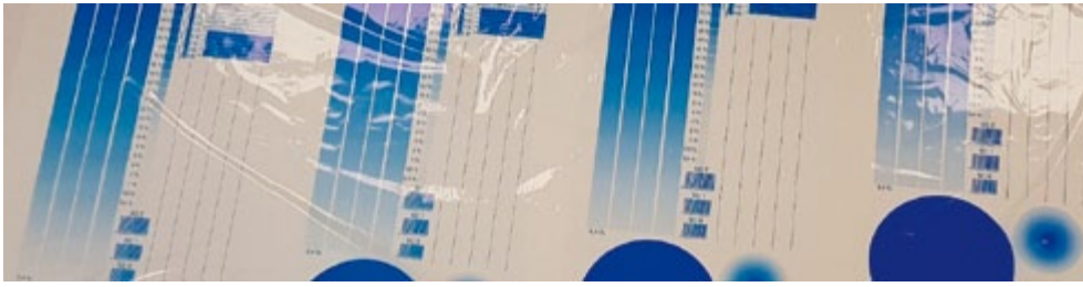
Abbildung 4: Ausschnitt eines Drucktests mit einer TeroLux-Bänderwalze mit verschiedenen 60°-Hexagonalgravuren
